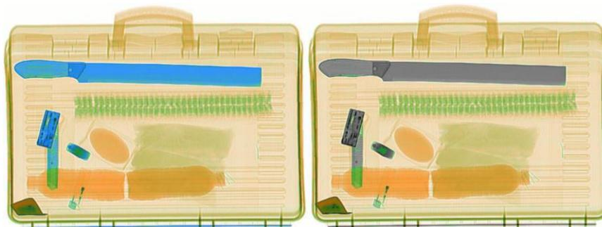
Рис. 5.10 Изображение с включенным фильтром неорганических материалов (справа)
