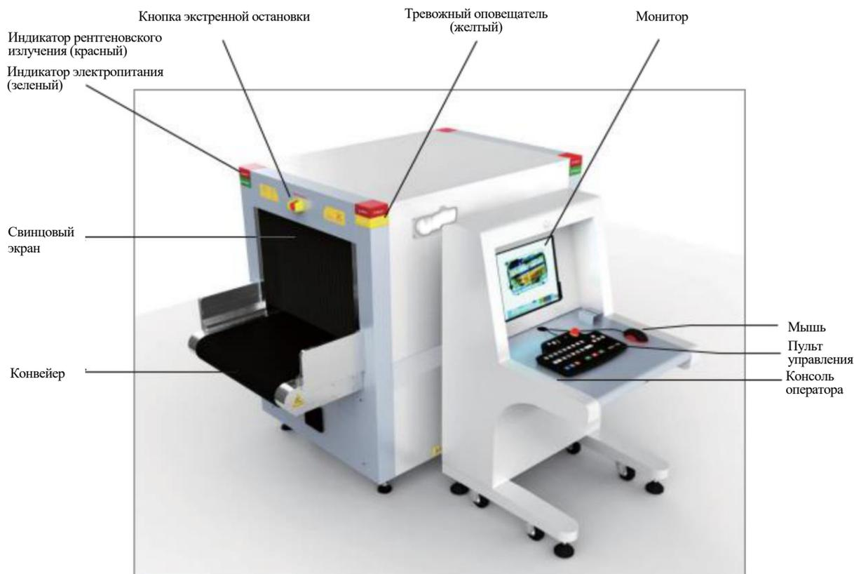
Рис. 3.1 Внешний вид интроскопа ML-BI-100100
